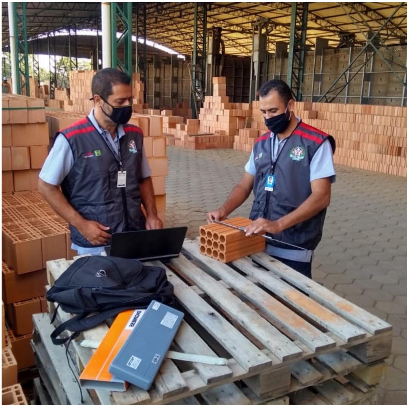
Além do exame formal (verificação da presença das informações obrigatórias no bloco cerâmico), os servidores do Ipem-MG realizaram o exame dimensional, no qual examinam as dimensões efetivas de largura, altura, comprimento, espessura dos septos (elemento laminar que divide os vazados do bloco) e espessura das paredes externas (elemento laminar externo do bloco).
